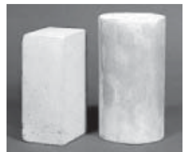
รูปที่ 1-7 หินของเกาะพอร์ตแลนด์ (ซึ่งเป็นที่มาของชื่อปูนซีเมนต์พอร์ตแลนด์) และตัวอย่างคอนกรีตรูปทรงกระบอก 8
